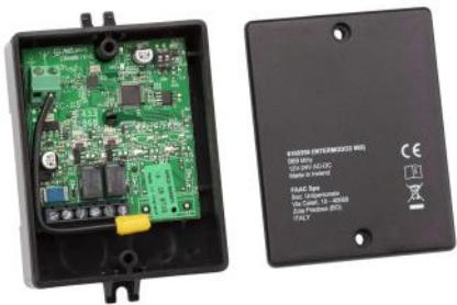
Riceventi da esterno bicanale e quadricanale, con collegamento filare, alimentazione 12-24 VAC VDC, provvista di decodifica del segnale radio integrata . Predisposta anche per fissaggio su guida a DIN.
